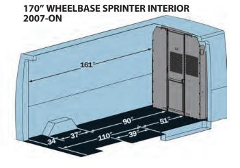
170" EXTENDED WHEELBASE SPRINTER INTERIOR 2007-ON
